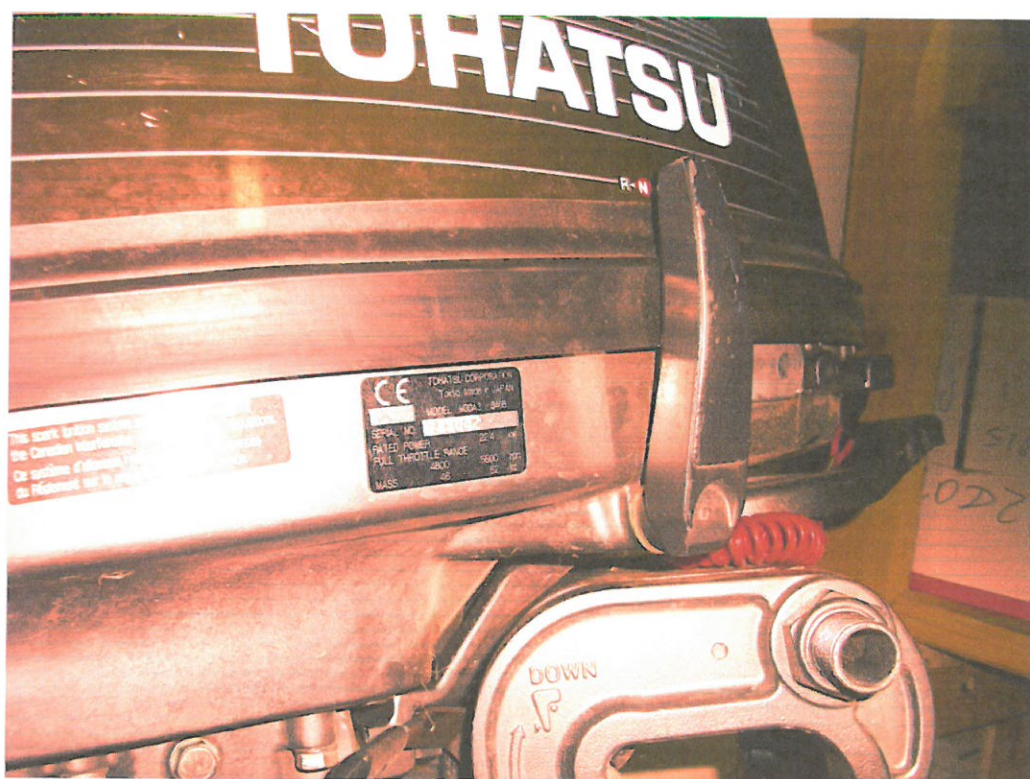
Tabliczka znamionowa z numerem seryjnym i typem silnika na korpusie silnika
