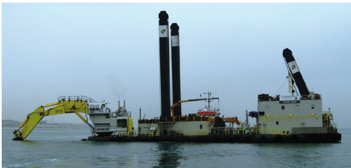
Rys. 3-8 Typowa pogłębiarka podsiębierna do prac wykopowych na płytkich wodach.
