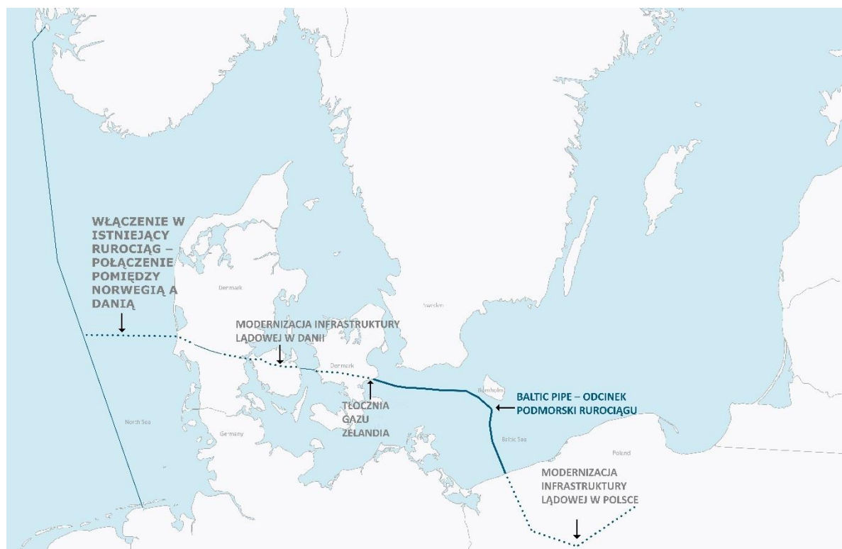
Rys. 1-1 Schemat pięciu najważniejszych elementów projektu Baltic Pipe.
