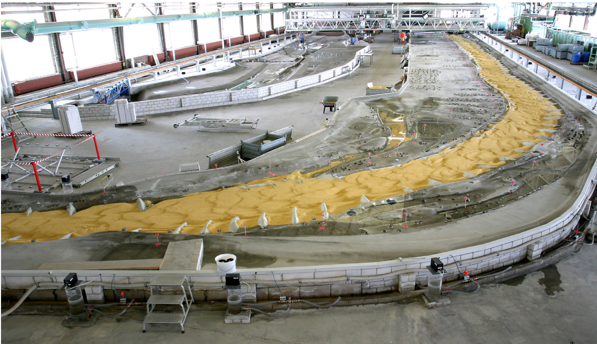
Ilustracja 2-3: Model fizyczny Odry przy m. Hohenwutzen w hali badawczej BAW
