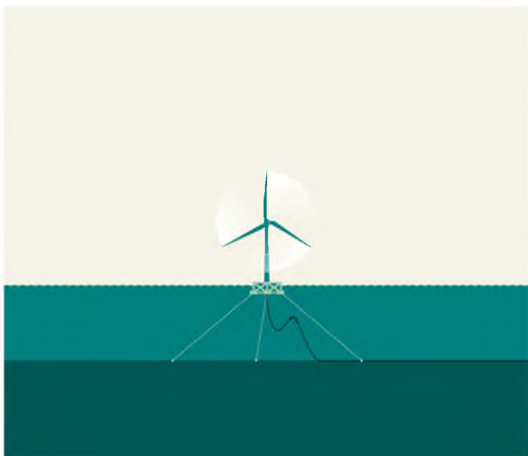
Rysunek 13. Fundament pływający podłączony do kabla dynamicznego, który porusza się wraz z fundamentem.
