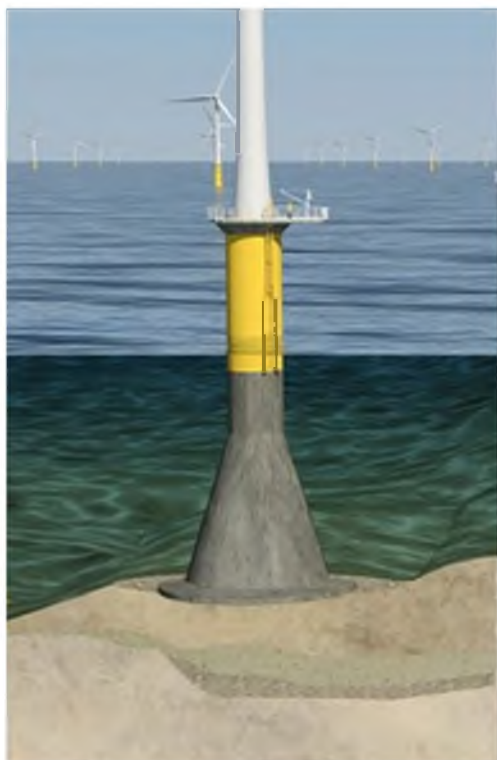
Rysunek 8. Fundament grawitacyjny. Ilustracja COWI
