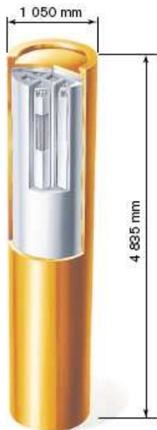
Rys. 7. Zbiornik miedziany z wypalonym paliwem jądrowym.
