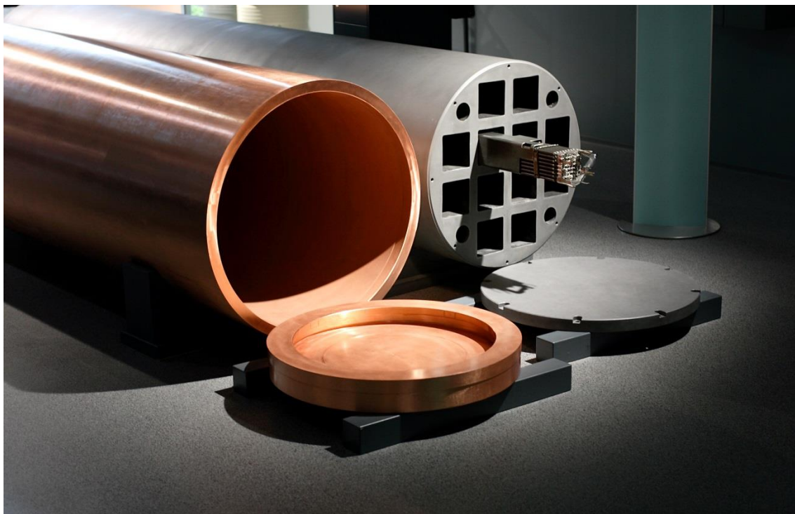
Rysunek 2. Wkład i zewnętrzny płaszcz pojemnika do składowania. Na rysunku widać pojemnik dla Olkiluoto 1 i 2. Ma on średnicę 1,05 metra i 4,8 metrów długości. Źródło rysunku: Posiva Oy. Pojemniki Fennovoima będą nieznacznie dłuższe i będą mieć inny rodzaj wkładu.
